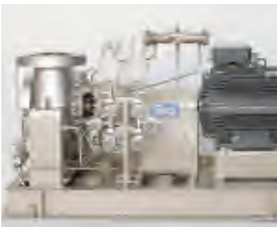
Bomba de circulación del calentador (PRNR, ENSIVAL) con un sello SHV1/57-EF1 y un intercambiador de calor WED20. ( t = 325\text{ }^{\circ}\text{C} ; H = 122.95\text{ kg/cm}^2 ; p = 120.5\text{ bar} )
