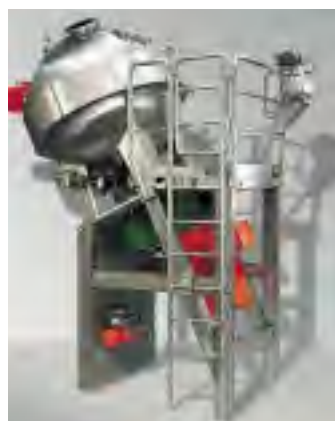
Secador esférico (Rosenmund Gueda) para la producción de polvos farmacéuticos con HSMR5L-D de Burgmann (ejes principal y tajador).
