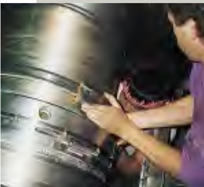
Sello sencillo VGM de Burgmann de diseño completamente dividido (parte superior). Montando el sello en el eje de una turbina (parte inferior).
