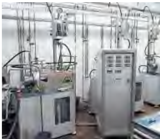
Equipos de prueba de alta presión para realización de pruebas de desempeño de los materiales de las superficies de sellado
