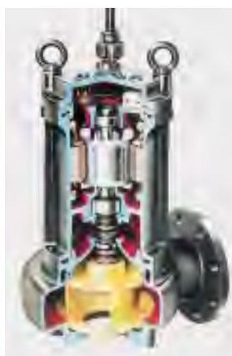
Bomba sumergible (HOMA, tipo A) para bombeo de sitio fijo de aguas residuales, aguas negras y sedimentos. Esta está sellada con un sello Tipo MG1 de Burgmann en arreglo tandem. ( Q = \dots 1,800 \text{ m}^3/\text{h} ; H = \dots 60 \text{ m} ).
