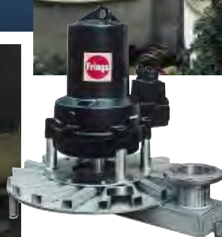
Un rociador sumergible (Frings) para enriquecimiento de oxígeno de bacinicas de aguas residuales. Las unidades de este tipo están selladas exitosamente con sellos mecánicos MFL85 N y MG1 de Burgmann.
