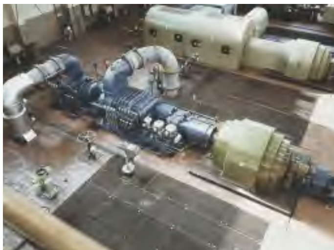
Compresor de etileno (Demag Delaval) en la Planta Petroquímica Yanshan (China). Sellado con PDGS1/195 de Burgmann, libre de elastómero. P_1 = 3.8 \text{ bar} ; t = 80 \text{ °C} ; v_g = 100 \text{ m/s} ; n = 7,830 \text{ min}^{-1} .
