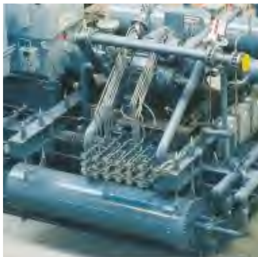
Compresor de CO (Atlas Copco) en Alkos, Yochon/Corea, con un sello de gas DGS2/49 de Burgmann. P_1 = 2.2 \dots 28 \text{ bar a} ; n = 21,700/34,800 \text{ min}^{-1} ; fluido: monóxido de carbono.
