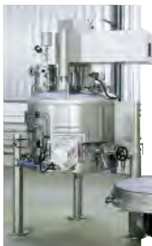
◀ Secador de filtro (Rosenmund Gueda) con M451 KL(T)-D y AGS451 KL-D de Burgmann ( p_1 = vacío ... 6 bar; t_1 = -20 ... 200 °C; n = 5 ... 50 min -1 ; movimiento axial = 100 ... 700 mm).
