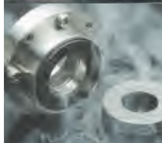
Bomba de nitrógeno en una estación de carga usada por Linde AG. El sello MFLC-GS lubricado con gas de Burgmann ha estado funcionando sin problemas desde abril de 1998. P_1 = 5 bar; t = -196 °C; n = 2,950 min -1 . Más bombas móviles ( n = hasta 11,000 min -1 ) en camiones tanque o cisterna también siendo sellados exitosamente con el MFLC-GS.
