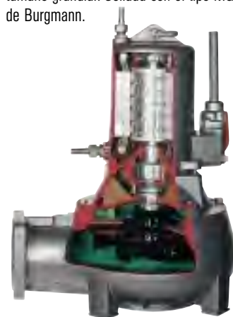
Bomba sumergible (Jung, UAK) con sello mecánico tipo MG1. ( d_1 = 45 \text{ mm} ; p_1 = 10 \text{ bar} ; t = 120^\circ\text{C} ; n = 2,920 \text{ min}^{-1} ; Q = 500 \text{ m}^3/\text{h} ).
